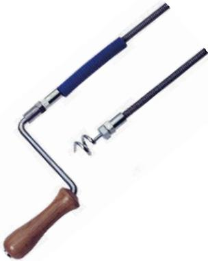
Mehrdrähtig gewickelte Rohrreinigungswelle mit Seele, auswechselbarer Kralle und Kurbel. Verlängerbar, mit Kupplung 1/2" Ww.
